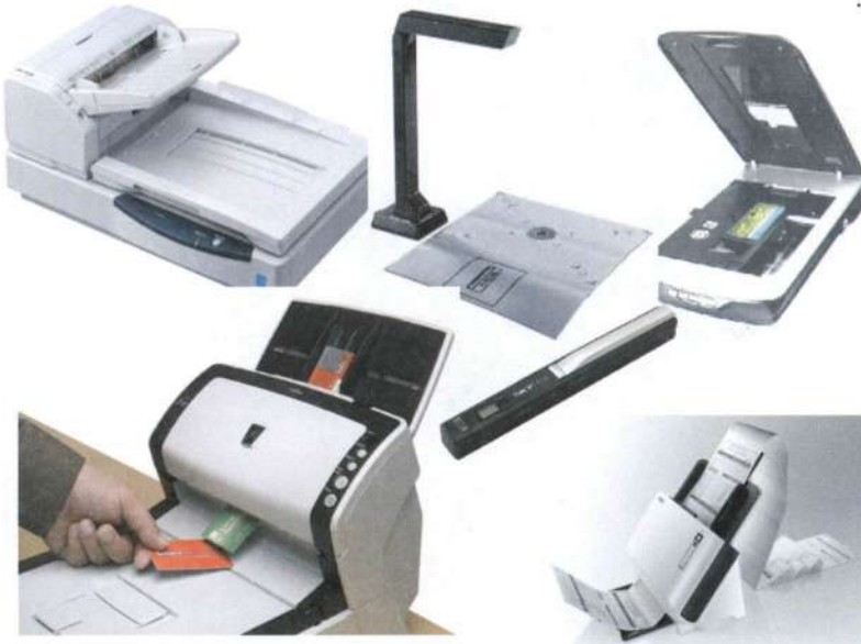
الشكل (2-12) أنواع مختلفة من الماسحات الضوئية (حسب حجم المستندات، وطريق الاستخدام)
