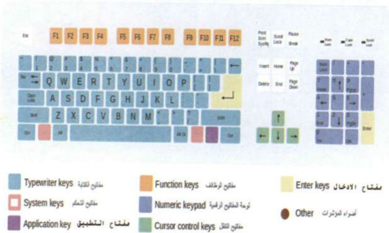
الشكل (2-4) التقسيم النموذجي للوحة المفاتيح
